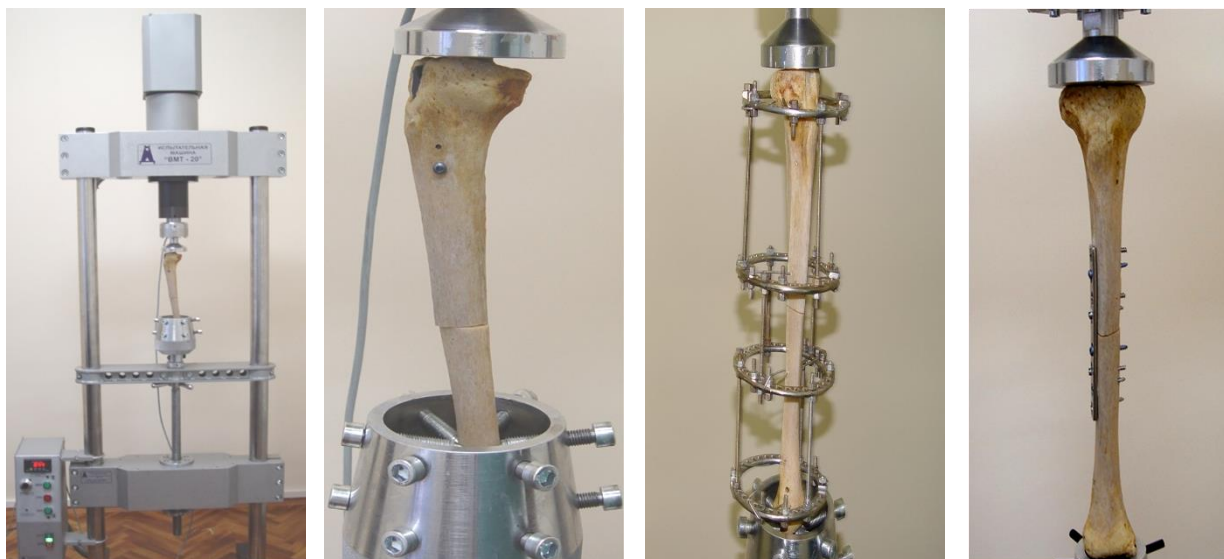
Рисунок 3 – Испытание модели на «сжатие».
